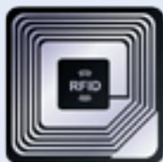
Машиночитаемые тэги используют радиоволны для взаимодействия с приемным устройством. Содержат электронный чип, хранящий данные.
